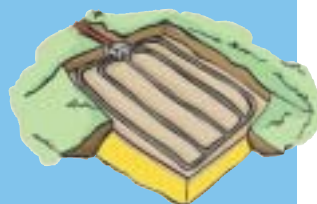
Dispositif d'épuration surélevé Tertre d'infiltration
